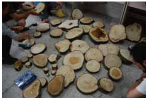
採集した幹の円盤。木部の変色や腐朽の具合を調べたり、年輪から成長を調べます。腐朽部からは菌を分離して同定します。
