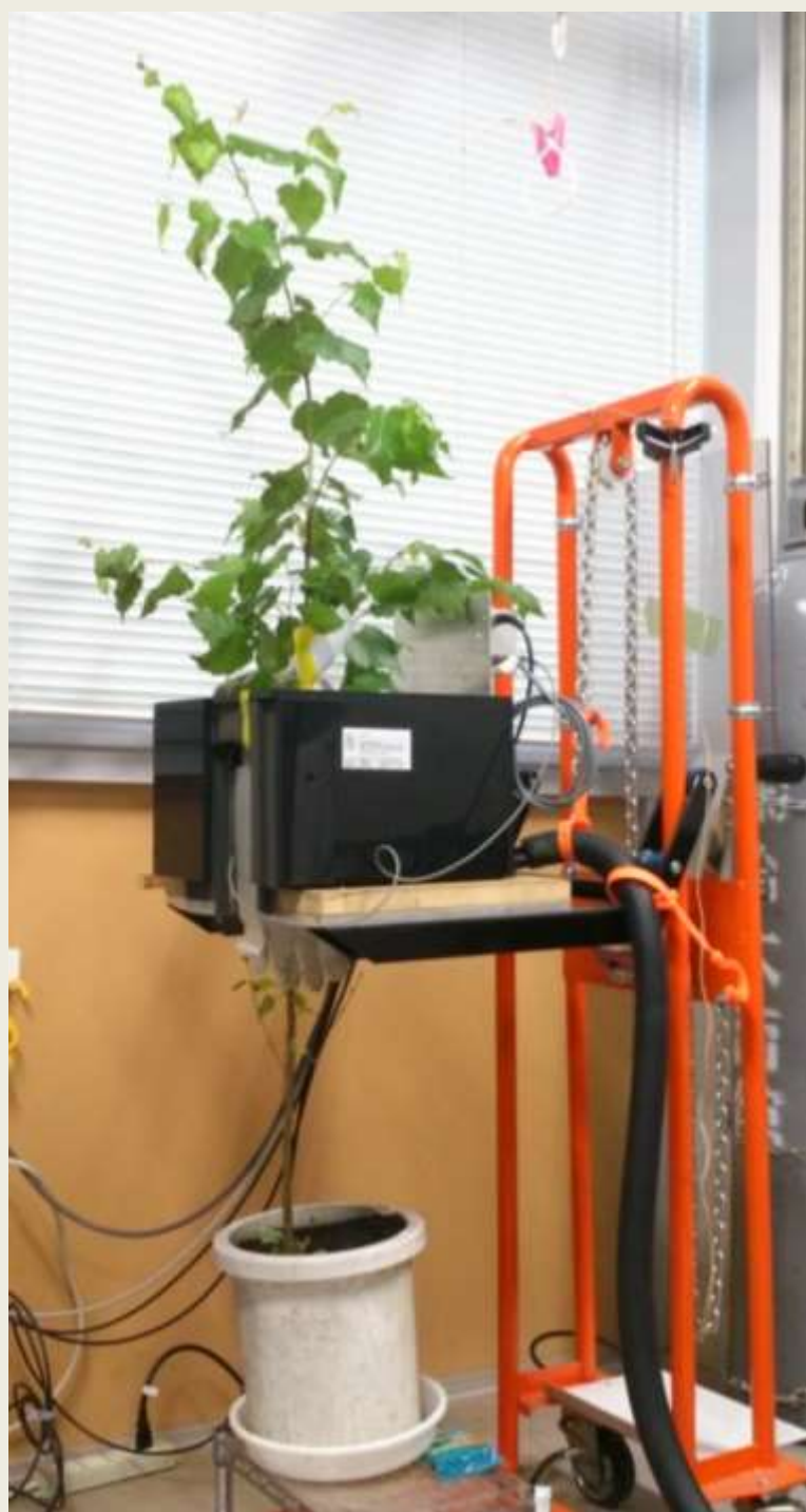
MRIによる樹幹内部の撮像の様子。幹の内部の水分布を非破壊的に、継続的に観察しています。
